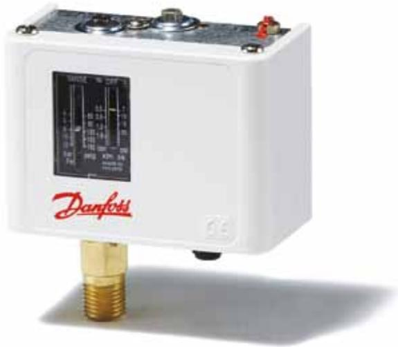
Os pressostatos KPI da Danfoss são usados para controle, monitoramento e sistemas de alarme em aplicações industriais. A série KPI é adequada para instalação em conexão com meio líquido e gasoso. São equipados com contato elétrico de polo simples (SPDT).
