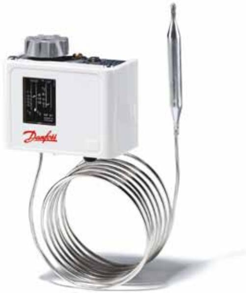
Os termostatos Danfoss KP são usados em sistemas industriais de controle, monitoramento e alarme. A linha de termostatos KP são interruptores elétricos ativados por temperatura com contatos (SPDT), que podem controlar diretamente os motores CA monofásicos de até 2 kW.
