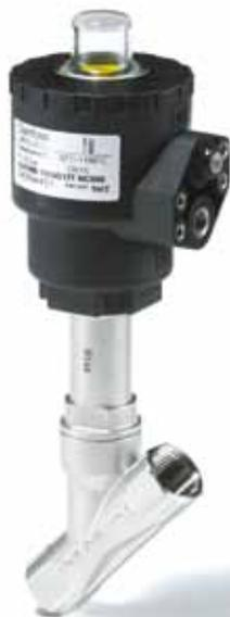
AV210 é uma válvula de assento angular operada externamente para uso em aplicações industriais exigentes. A válvula pode operar em meios com temperaturas e viscosidades muito altas e é resistente a partículas de sujeira; por isso, geralmente é chamada de válvula "solucionadora de problemas". A válvula está disponível em bronze (RG5/bronze) e aço inoxidável (AISI316).
