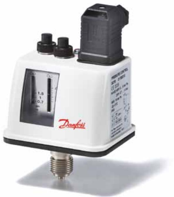
O tipo BCP é uma série de pressostatos dedicados para controle, monitoramento e segurança de caldeiras de água quente e vapor. O BCP incorpora um contato elétrico de pólo simples onde a posição de contato depende da pressão do "setpoint" e do valor definido do diferencial. Para instalações em que a operação é particularmente crítica por motivos de segurança, é recomendável o uso de controle à prova de falhas.
