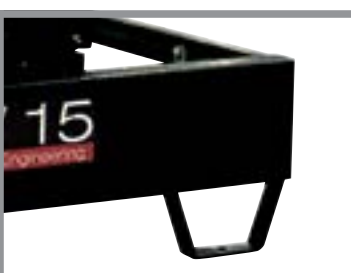
Patas de apoyo soldadas a la bancada
