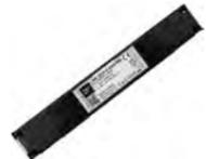
Este equipo permite regular la intensidad de salida mediante la app Casambi o por pulsador normalmente abierto (NA). Incorpora 5 salidas y 2 entradas de pulsador. Se pueden configurar varios perfiles (5 Blancos, 2xTW, RGB+WW, RGB+TW...). Iout: 12A máximo
