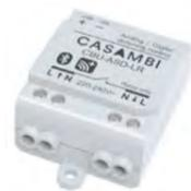
Controlador Casambi para equipos regulables mediante DALI o señal 0-10V. Tiene una salida para alimentar un relé de 230Vca. Se puede configurar como entrada de pulsador. Salida DALI activa para 1 driver
