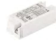
Driver con salida en corriente constante. La corriente se puede ajustar entre 700-1050mA mediante Dip-switch. Con entrada de pulsador (es un pulsador Casambi) para poder controlar luminarias, grupos, escenas, etc
