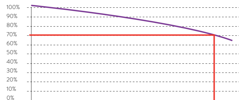
Tasa de vida útil para productos LED en base al 70% de mantenimiento del flujo luminoso
