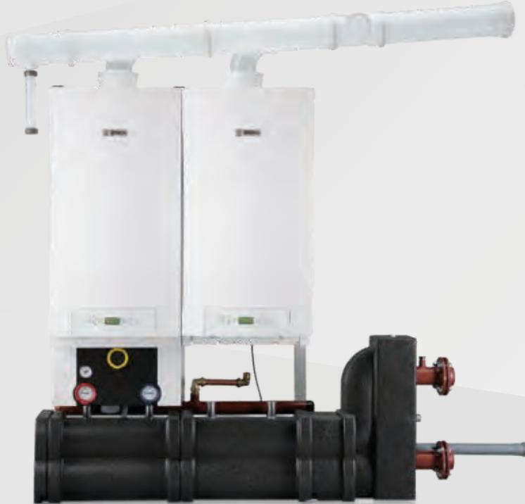
Exemplo de uma instalação de 4 caldeiras em cascata, com o sistema de controlo EMS 2.0 combinado com o módulo MC400 para cascatas, com controlo de 2 circuitos de aquecimento e 1 de A.Q.S. através dos módulos adicionais MM100. Tudo isto sob a gestão do controlador CW400.
