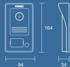
Placa de calle de vídeo WAY-FI. Montaje de superficie. Fabricada en aluminio. IP 44 IK 07. Tarjetero con retroiluminación. Visera de protección incluida, necesaria en la instalación. Cámara CMOS color gran angular (120°H 72°V). Sensor de iluminación. Temperatura de funcionamiento: -20°C a 55°C. Dim.: 94(H) x 164(V) x 34(P)mm (con visera). Relé integrado para apertura de una 2ª puerta. Consumo máx. abrepuertas: 250mA.
