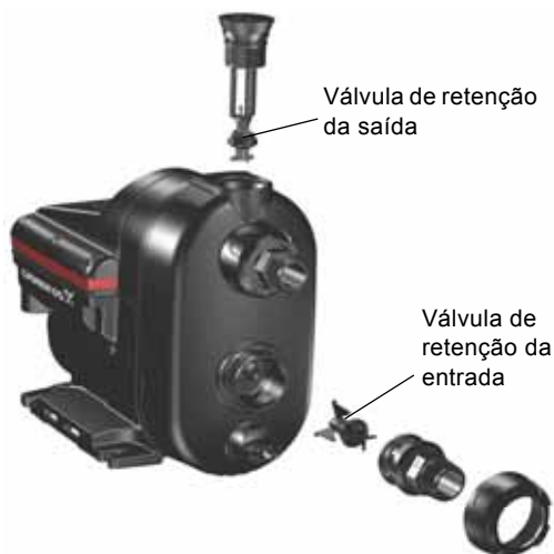
Fig. 21 Válvulas de retenção da saída e da entrada
