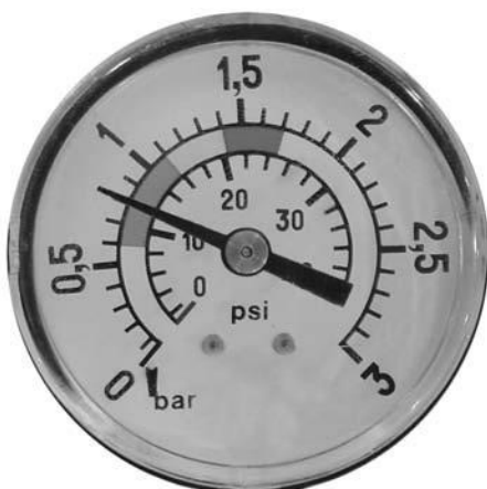
0,8 kg/cm 2 - 11,4 PSI: Normaldruck bei Beginn des Filtriervorganges.
