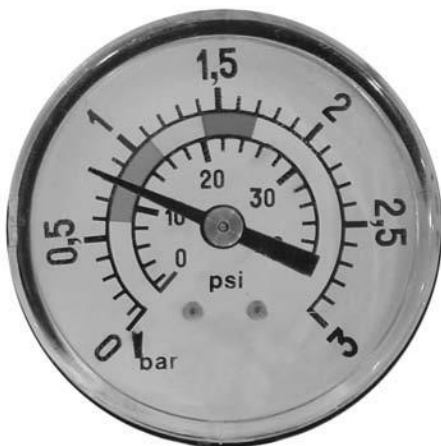
0,8 kg/cm 2 - 11,4 PSI: Presión normal al iniciar un ciclo de filtración.
