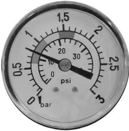
0,8 kg/cm 2 - 11,4 PSI: filitreleme sürecinin başındaki normal basınç
