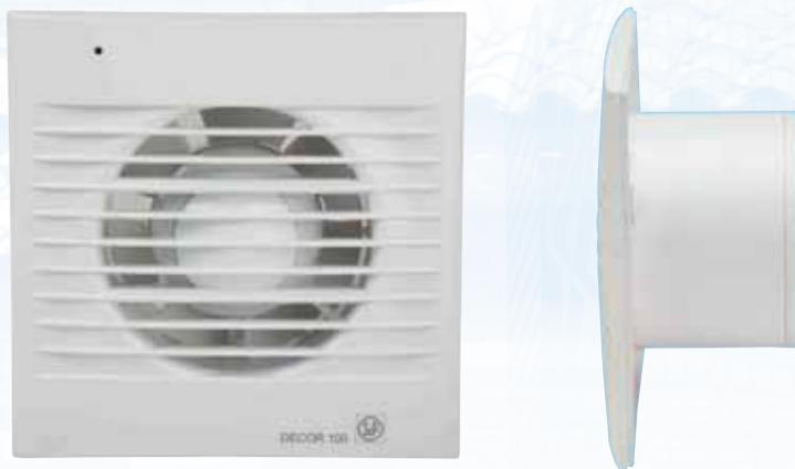
Ventiladores helicoidais extra-planos, caudal aproximado de 100 m<sup>3</sup>/h, obturador anti-retorno incorporado, luz piloto de funcionamento, motor 230V-50Hz, IP44, Classe II, com protector térmico, para trabalhar a temperaturas até 40°C.
