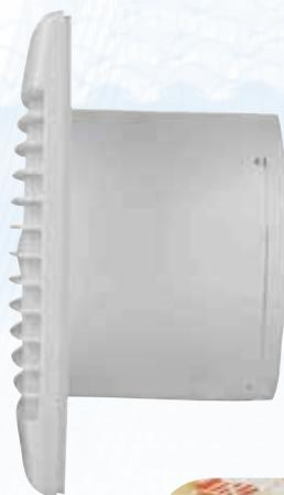
Ventiladores helicoidais **extra-planos**, caudal aproximado de 200 m<sup>3</sup>/h, obturador anti-retorno incorporado, luz piloto de funcionamento, motor 230V-50Hz, IP44, Classe II, com protector térmico, para trabalhar a temperaturas até 40°C.
