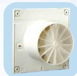
Obturador anti-retorno que evita a entrada de ar do exterior e fugas de aquecimento, quando o extractor não está em funcionamento. Abre-se por pressão do ar.
