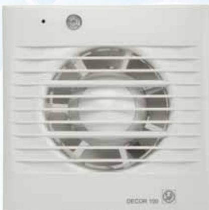
Dispõem de detector de presença. O aparelho entra em funcionamento de forma automática quando detecta movimento a uma distância máxima de 4 metros. Incorpora também um temporizador regulável entre 1 e 30 minutos, período durante o qual o aparelho continua a funcionar depois de deixar de detectar movimento.
