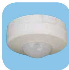
CPFL-S / CPFL-E Detectores de presença, sensíveis às radiações infravermelhas devidas ao calor que emitem os corpos em movimento, com um ângulo de detecção de 360°.
