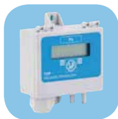
TDP-S / TDP-D Transmissores de pressão. Utilizam-se para controlar a pressão nos sistemas de ventilação em pressão constante. Permitem a leitura da diferença de pressões entre dois pontos e transformam-na em um sinal eléctrico apto para os diferentes equipamentos de controlo.
