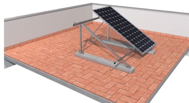
Instalación correcta de triángulo abierto sobre bordillos de hormigón
